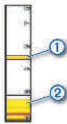
Im oben abgebildeten A-Scope sind Fischsignale ① und Signale für einen weichen Boden ② zu sehen.
