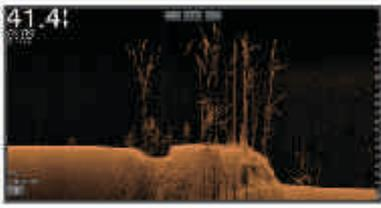
Traditionelle Geber senden einen konischen Kegel. Die Garmin ClearVü Scanning Echolottechnologie sendet zwei schmale Kegel, die dem Strahl in einem Kopiergerät ähneln. Diese Kegel produzieren ein klares, realitätsnahes Bild der Ansicht unter dem Schiff.
